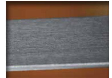
Längsschliffbild, die Walzhaut wurde komplett abgeschliffen.
