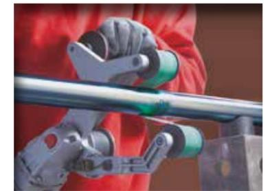
Sauber verschliffene Schweißnaht.
