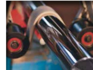
Tragen Sie die Polierpaste gleichmäßig mit geringer Drehzahl auf das Filzband auf. Wählen Sie bei der Netzmaschine zum abschließenden Spiegelglanzpolieren Stufe 6\*.
