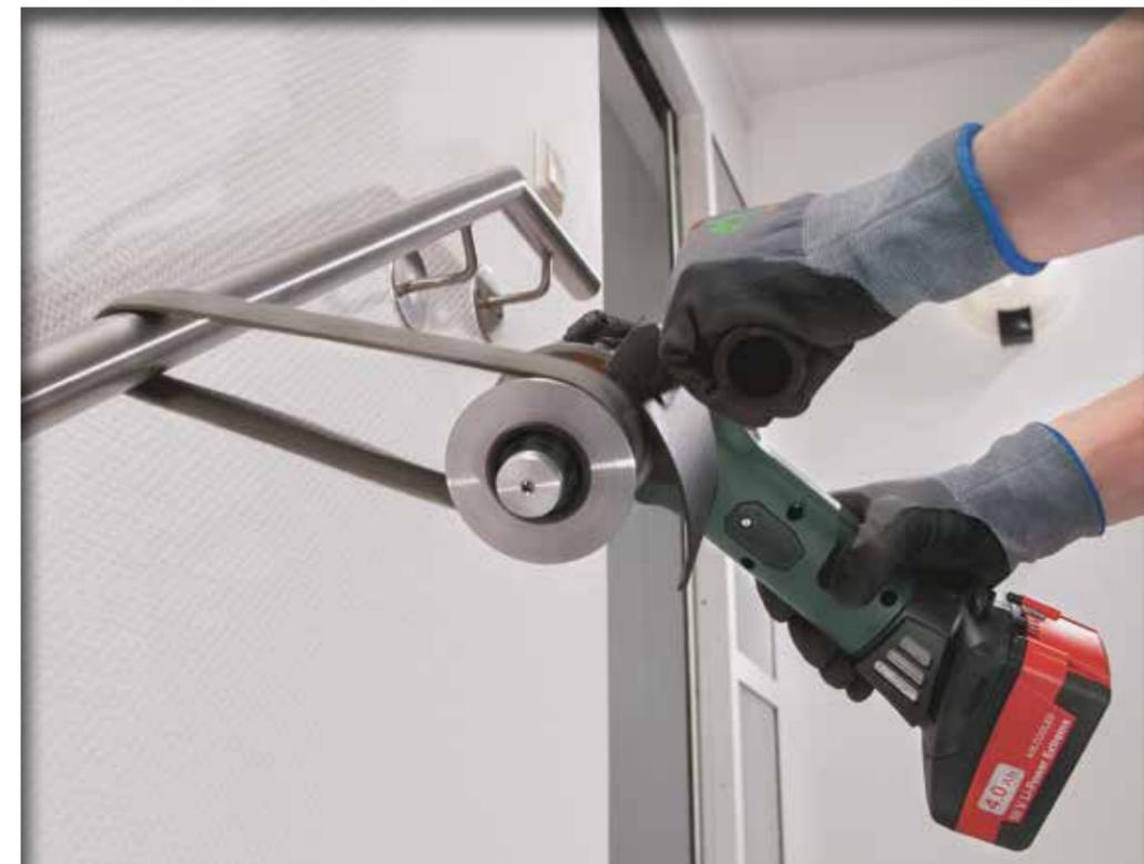
Wählen Sie Drehzahlstufe 3\* und überschleifen Sie leichte Kratzer mühelos, ohne Riefen. Sie erhalten eine optimal satinierte Oberfläche auch bei geringsten Wandabständen.
