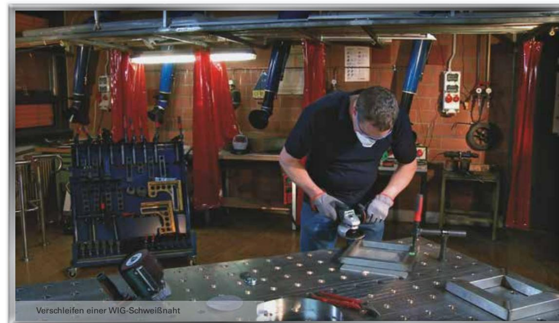
Verschleifen einer WIG-Schweißnaht
