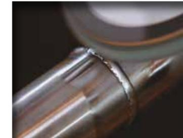
Wählen Sie beim netzbetriebenen Winkelschleifer die Drehzahlstufe 2\* und entfernen Sie mühelos Anlauffarben an feinen WIG-Schweißnähten.
