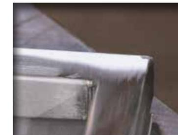
„Plan“ verschliffene Schweißnaht.
