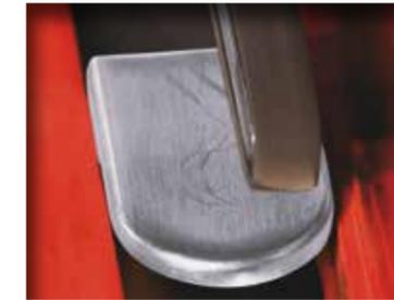
Flächiges Ausschleifen der Kratzer in Stufe 6\* mit Schleifbandarm 6.26381.
