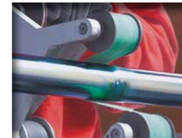
Hohe Abtragsleistung bei extrem hoher Standzeit: Wählen Sie die Drehzahlstufe 6\* und entfernen Sie eine WIG-Schweißnaht in Sekunden.
