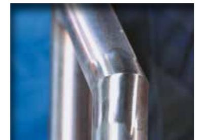
Sauber verschliffene WIG-Schweißnaht ohne „Facettenschliffbild“ mit leichtem Rotationsschliffbild.
