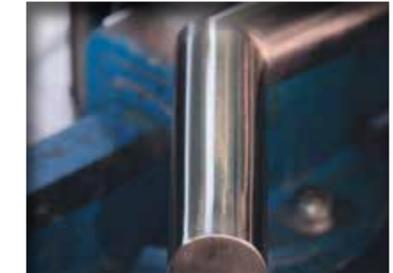
Perfekte Oberfläche, die Kratzer wurden komplett ausgeschliffen.
