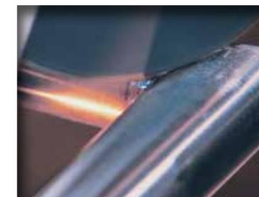
Dank der extrem flachen Bauweise erreichen Sie mit dem Kehlnahtschleifer auch besonders spitze Winkel. Wählen Sie Drehzahlstufe 5\* und entfernen Sie mühelos die Kehlnaht ohne angrenzende Oberflächen zu beschädigen.
