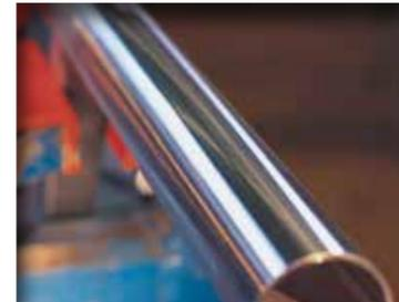
Vorgeschliffene Oberfläche mit Pyramid Schleifband A6.
