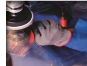
Finales „Abglänzen“ mit weichem Teller und weichem Haftpolierfilz in Verbindung mit blauer Polierpaste auf Drehzahlstufe 4-5\*.
