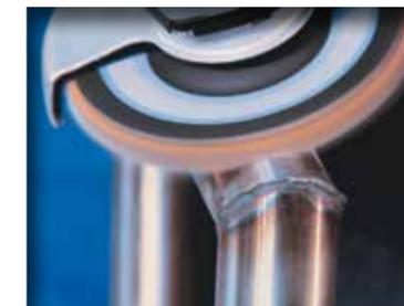
Wählen Sie Drehzahlstufe 3\* und verschleifen Sie die feine Schweißnaht quer zum Handlauf. Angrenzende Oberflächen werden nicht beschädigt.
