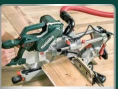
Kompakte Zugfunktion für breite Werkstücke
